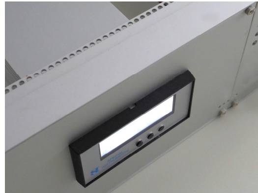
Einbau des Geräts in die Frontplatte eines 19" Einschubs (Beispiel)
